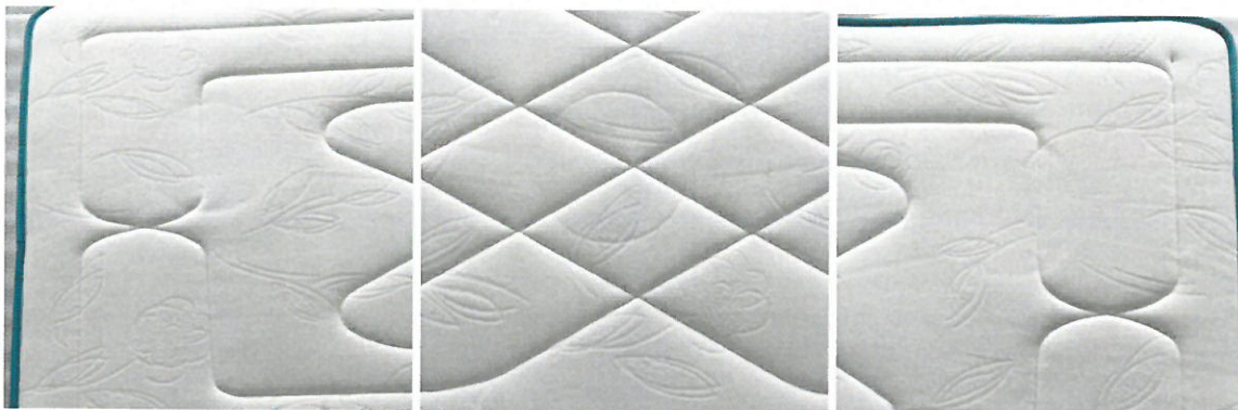
Obr. č. 7 – Vzorek č. 462204085/01 – detail otlaků zkušebního tělesa po provedení 10.000 cyklů
